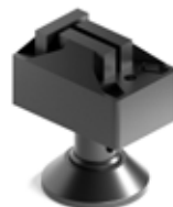
ST0012.VS000.BKSPC.QC STELLA Регулируемая опора В комплекте: корпус - 1 шт.; вкладка - 1 шт.; втулка - 1 шт.; крышка - 1 шт.; основание - 1 шт.; винт M4x12 - 1 шт.; саморез 4x30 - 1 шт. Цвет: черный матовый
